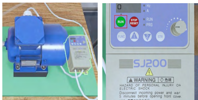
Wskazanie elementu aktywnego (zielona obwódka wokół konturu falownika) oraz widok na panel sterowania falownika
